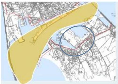
O projeto consiste no reacondicionamento do molhe norte, com reconstrução dos troços em estado de degradação acentuada, de forma a serem repostas as condições de proteção e segurança indispensáveis à exploração do porto, bem como no estabelecimento das cotas de projeto na barra, canal de acesso e bacias de manobra e acostagem, por forma a garantir o regular funcionamento do porto.
