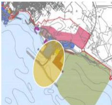
Este projeto compreende a expansão do Terminal de Contentores de Sines (Terminal XXI), para além do que se encontra atualmente contratado, dotando-o de uma infra-estrutura de cais de 1.230 metros, 12 pórticos de cais e uma área de armazenamento de 45 hectares, o que elevará a capacidade de movimentação para 2,3 milhões de TEU/ano.
