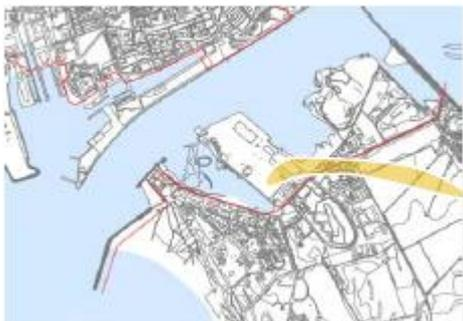
Ligação do porto à Linha do Minho, através da construção de um ramal desde a estação de Darque, com duplicação da linha existente até próximo da ponte Eiffel, donde deriva para o setor comercial do porto.
