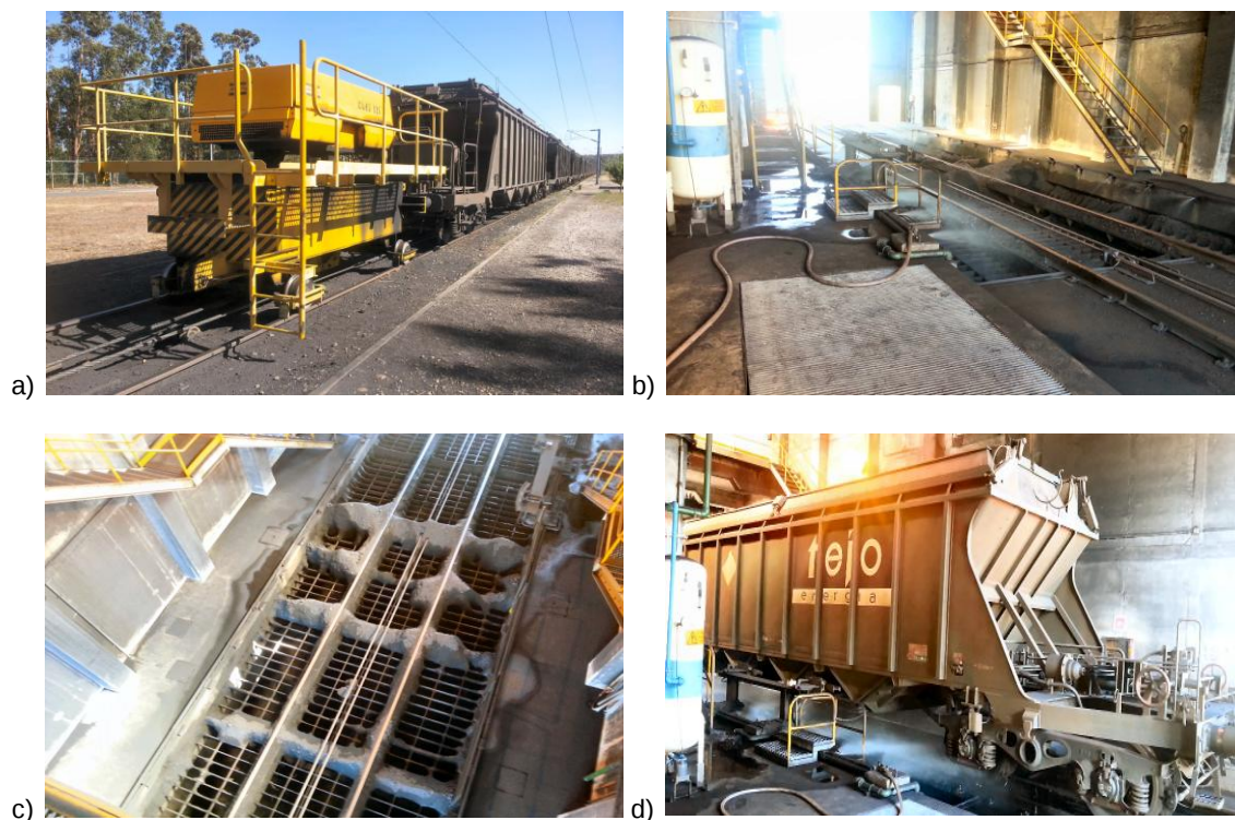
Figura 5.14 – Processo de descarregamento: a) Chegada do pusher car com o primeiro vagão; b) Tremonha de descarga preparada para receber o primeiro vagão; c) Vista geral do local de descarga; d) Vagão no instante imediatamente antes de abrir as comportas
