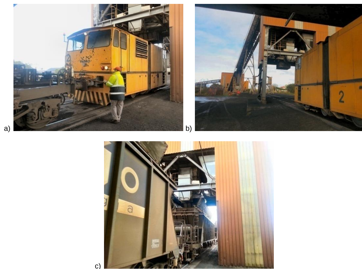
Figura 5.10 – Estação de Carregamento de Vagões (ECV): a) Engate do locotrator ao conjunto dos vagões; b) Vista geral do local de carregamento; c) Carregamento de um vagão
