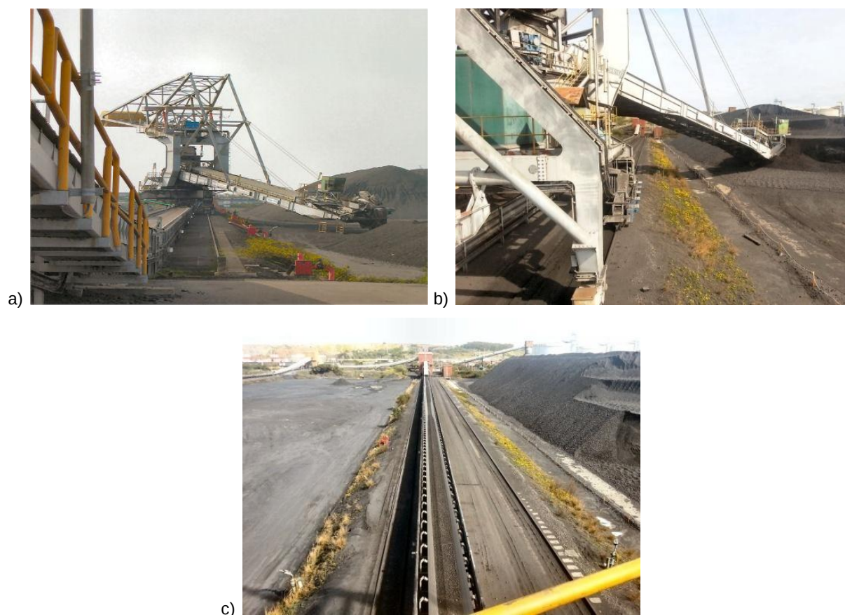
Figura 5.11 – Retoma de carvão do parque: a) Vista geral de um stacker/reclaimer ; b) Recolha de carvão da pilha pelo stacker/reclaimer para carregamento sincronizado dos vagões; c) Transportador de carvão (Mocho, 2015)
