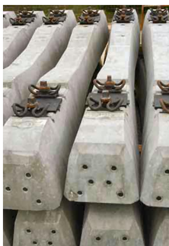
Figura 4.11 – Travessas polivalentes instaladas na Variante de Alcácer (REFER, 2010a)
